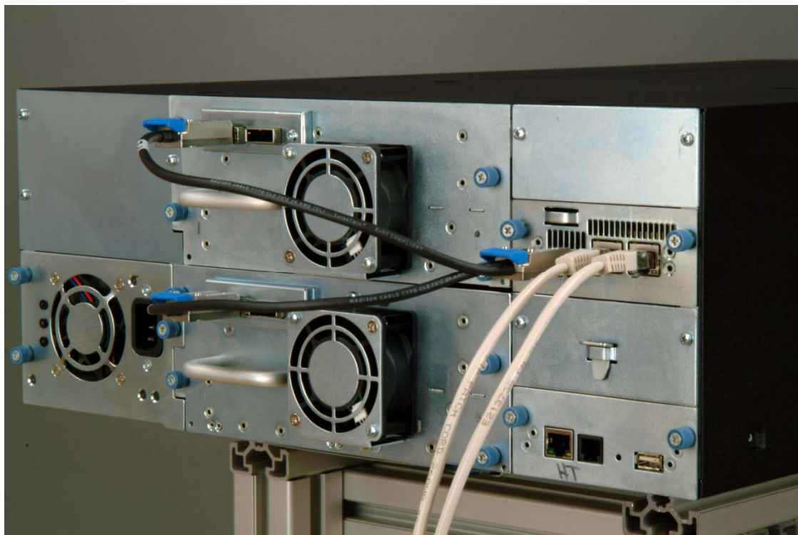
图 12 将 SAS 和网络电缆连接到 PowerVault TL4000 中
